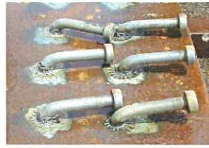
水中スタッド溶接の破壊試験
