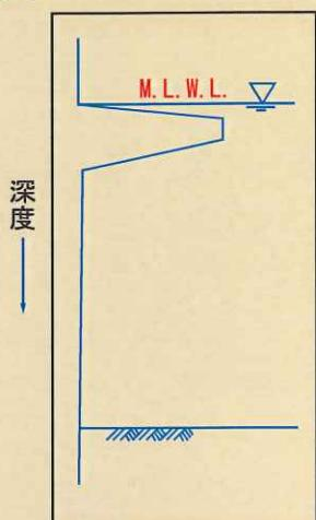
平均干潮面（M. L. W. L.）直下に、約0.2~0.1mm/yの腐食速度で進む大きな腐食が発生している場合
