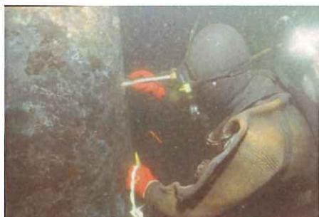
超音波肉厚計測による「肉厚測定」状況 鋼矢板の肉厚測定個所
